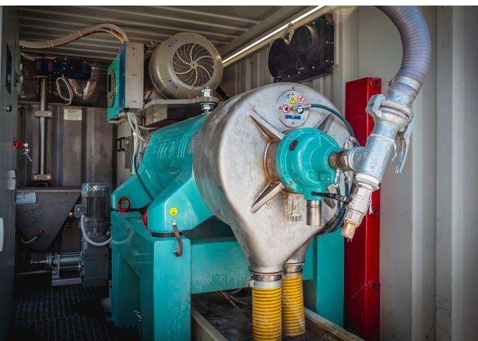
mo separa il prodotto in una parte solida e in un'altra liquida chiarificata. La quantità di solido e di liquido in uscita dipendono dalla densità dello spoil in entrata.
