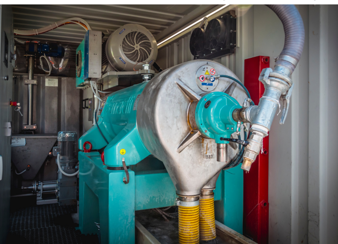
Decanter centrifugo GHT e scarico liquido.
