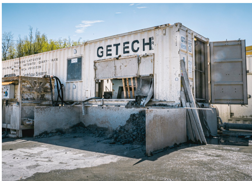
La coclea di evacuazione scarica il solido secco all'esterno.
